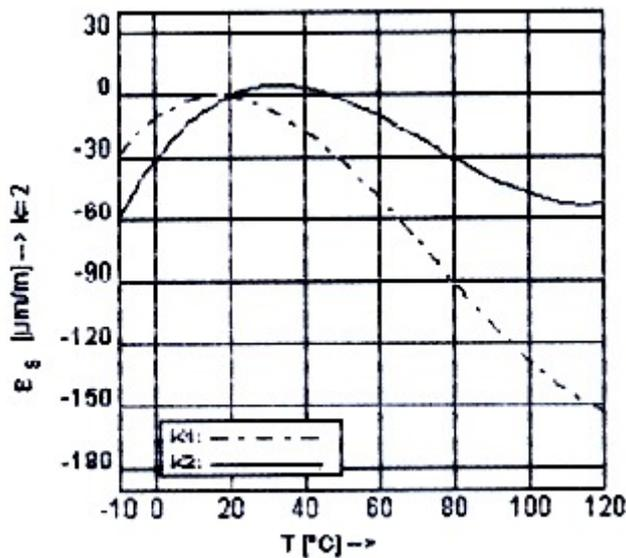
Die nebenstehende Abbildung zeigt die relative Längenänderung  $\epsilon_s$  eines Dehnungsmessstreifens (DMS) in Abhängigkeit von der Temperatur  $T$ .  $K_1$  ist die Kennlinie für einen DMS ohne Anschlussbändchen,  $K_2$  diejenige für einen DMS mit 30 mm langem Anschlussbändchen.
