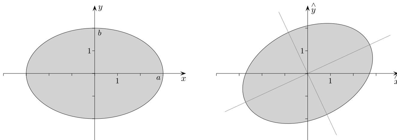
Die Hauptachsentransformation dient der einfacheren Darstellung der Kegelschnitte Ellipse, Parabel, Hyperbel und entsprechender rotationssymmetrischer Gebilde höherer Dimension. Es erfolgt ein Übergang vom  $\hat{x}\hat{y}$ -Koordinatensystem ins  $xy$ -Koordinatensystem.
